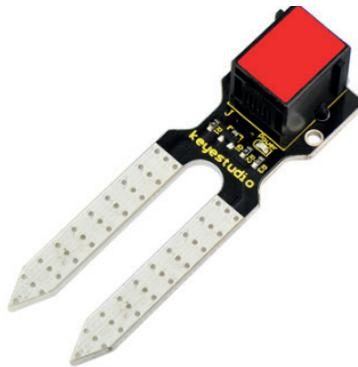
**b. Digitales:** son aquellos sensores que detectan cambios bruscos en magnitudes físicas y determinan si se está censando o no un fenómeno físico y le entregan al micro:bit un código de 0 o 1 dependiendo si se detecta o no el fenómeno. Todos los sensores digitales se programan de la misma manera, usando el bloque de lectura digital que se encuentra en la categoría Pines del MakeCode.
