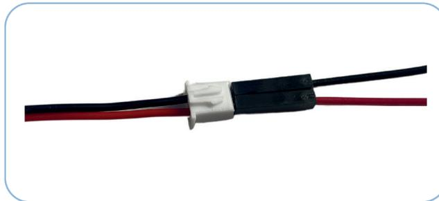
Verifique que conecte los cables hembra-macho en el puerto de motor de la tarjeta de expansión en el mismo sentido que lo haría si usara el conector original del motor.
